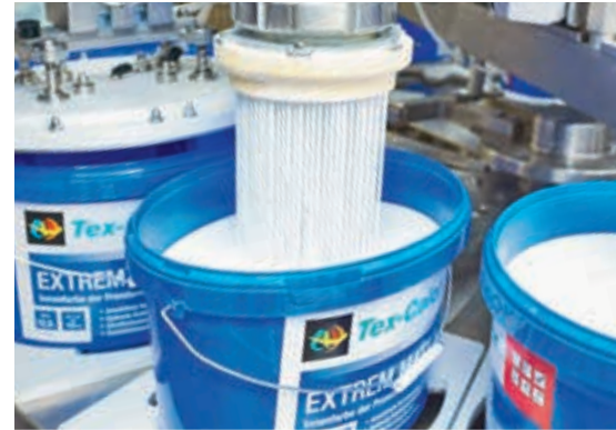
Dosierstation mit höchster Dosiergenauigkeit (≤ 0,1 % Standardabweichung)
