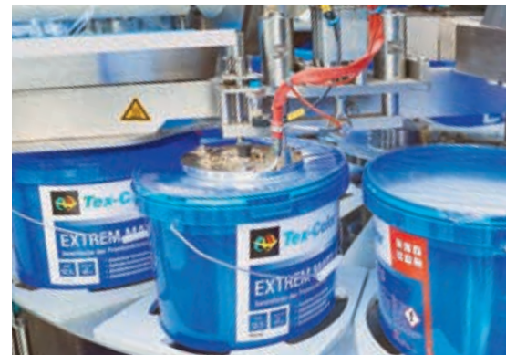
Dichtheitskontrolle der mit peelfähiger Sicherheitsfolie versiegelten Eimer
